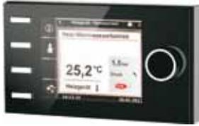
**Unidad de mando BM-2 como mando a distancia (sonda ambiente/termostato modulante) para circuitos de mezcla adicionales (si BM-2 está en la caldera, máx. 6 mandos a distancia adicionales) temperatura de impulsión en función de la temperatura exterior**
